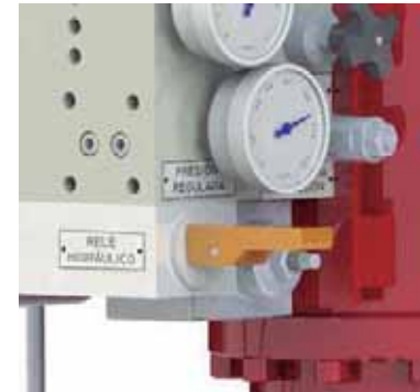
Gatillo en posición horizontal en posición activa
